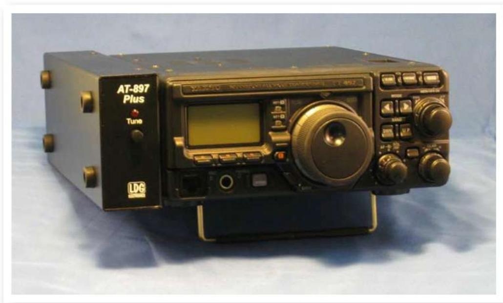
El **AT-897Plus** ha sido especialmente diseñado para el uso con el transceptor FT-857, y puede montarse al lado de éste. Los cuatro pies de la emisora encajan en el acoplador para que pueda ajustarla en el lado sin el peligro de rayar el acabado. Puesto que el **AT-897Plus** está pensado para ser integrado con su transceptor FT-897, también puede utilizar el acoplador por separado, es decir, sin estar montado en el transceptor FT-897.
